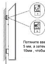
Снимаем обогреватель со стены
