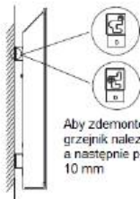
Demontaż urządzenia ze ściany
