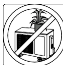
Achten Sie darauf, dass der Luftein- und -austritt nicht blockiert ist!
