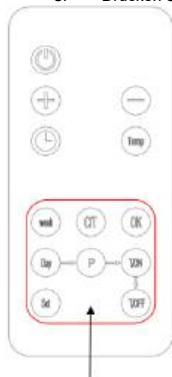
Kontrollbereich der Wochenschaltuhr
