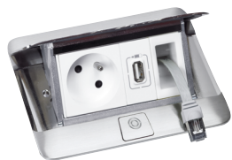
6540 00 wyposażona w mechanizmy Mosaic 1 x gniazdo 2P+Z + 1 x gniazdo ładowania USB + 1 x moduł z kablem zwijającym RJ45 cat 6
